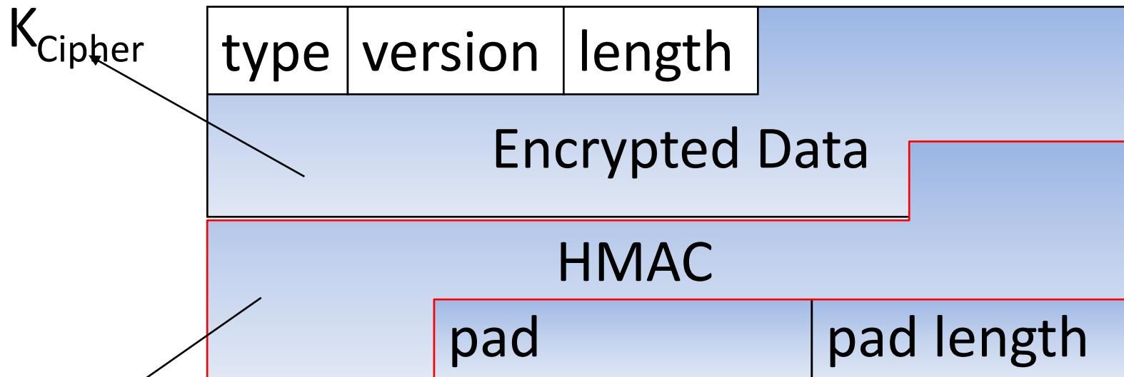
$\text{MAC} = \text{hmac}(K_{\text{auth}}, \text{uint64\_seq\_num} \parallel \text{type} \parallel \text{version} \parallel \text{length} \parallel \text{message})$
