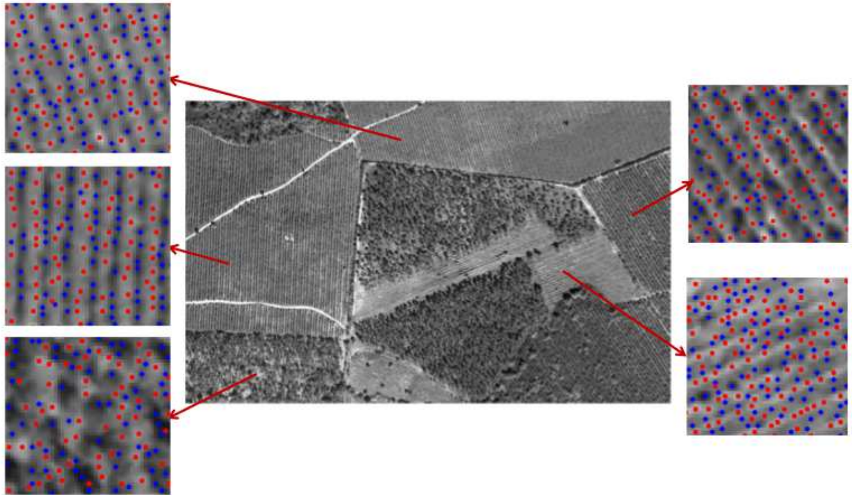
Figure 2 – Représentation de variété des points clés de \mathcal{S}_\omega^{\max}(I) (en rouge) et \mathcal{S}_\omega^{\min}(I) (en bleu) sur une image Pléiades ayant des textures locales différentes.
