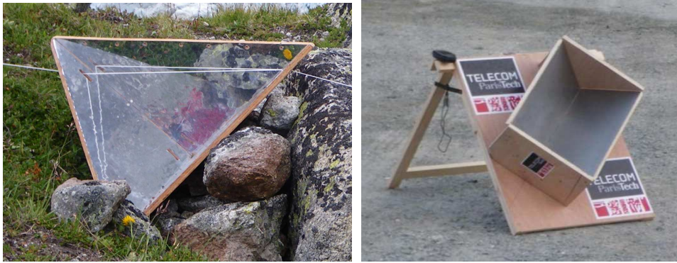
FIGURE 2.1 – Cibles canoniques. A gauche, trièdre en bordure du glacier d’Argentière. A droite, dièdre dépolarisant en test à Argentière.
