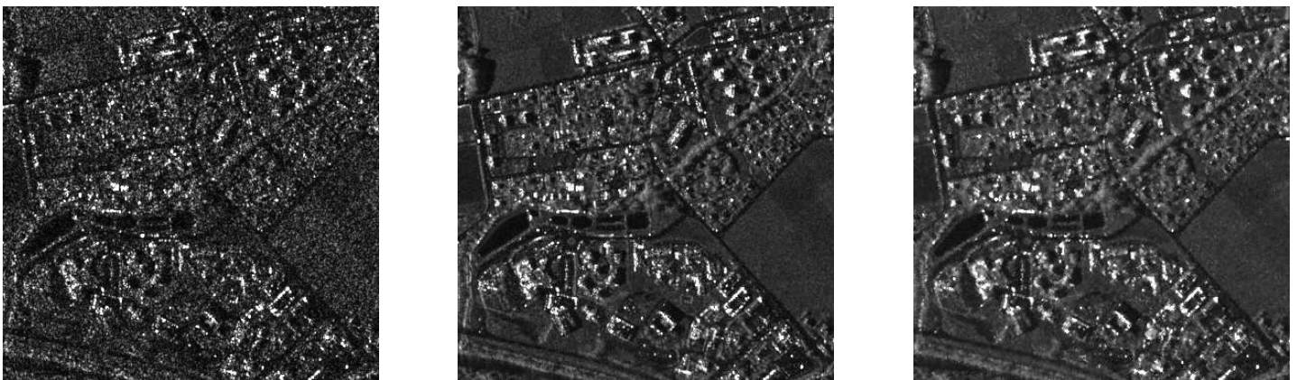
FIGURE 2.15 – Exemple de traitement multitemporel sur des données Terrasar-X acquises sur une zone résidentielle du Fayet (74). A gauche, une des 26 images disponibles (©DLR). Au milieu, la moyenne géométrique. A droite, le résultat d’un filtre de Lee construit à partir de l’image 1 : on peut noter que certains points brillants spécifiques de cette image sont conservés par ce filtre alors que la moyenne géométrique les avait “gommés”.
