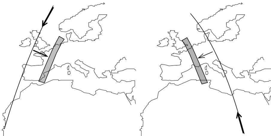
FIGURE 1.18 – Capteur RSO visant à gauche. Passe descendante (à gauche) et passe montante (à droite). Seuls certains capteurs permettent cette modalité.
