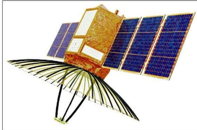
FIGURE 1.29 – L'antenne de RISAT-2 (©IAI).
