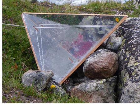
FIGURE 7.4 – Cible canonique, cas du trièdre : *Corner reflector* expérimental placé sur la rive droite du glacier d’Argentière (expérimentations du projet EFIDIR en 2011 lors d’acquisitions Terrasar-X). Le côté du coin cube fait environ 40cm.
