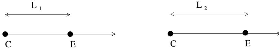
FIGURE F.18 – Géométrie Doppler : cible fixe et antenne en mouvement. A gauche, position en  $t_1$ . A droite, position en  $t_2$ .
