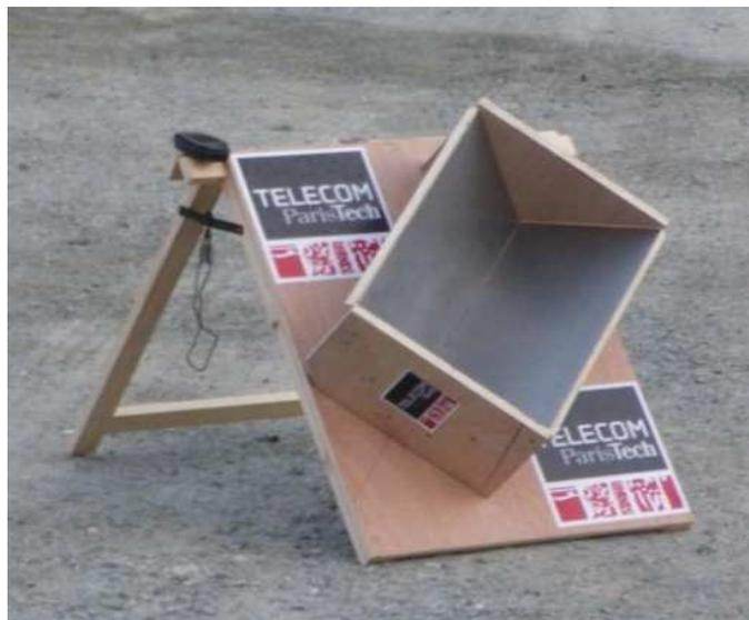
FIGURE 7.9 – Cibles canoniques. Dièdre dépolarisant en test à Argentièrre lors des expérimentations du projet EFIDIR (acquisitions d’images Terrasar-X en mode *Quad Pol* du 24/04/2010).
