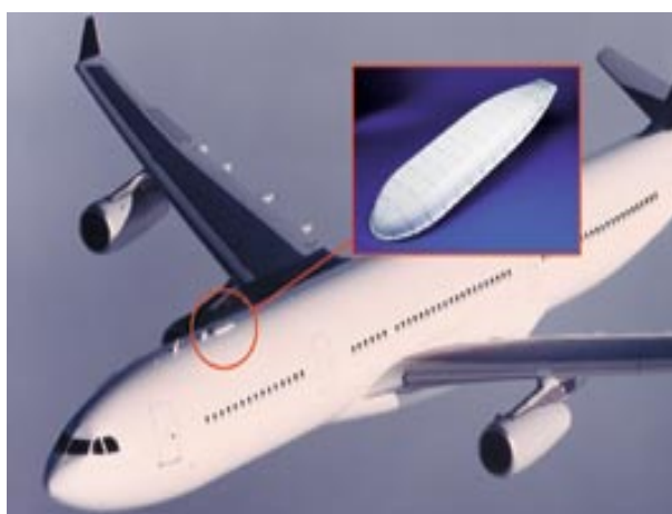
FIGURE 1: Implantation dorsale de l'antenne INMARSAT sur un A340.
