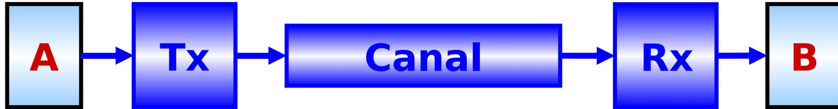
Le schéma de transmission « point à point » entre **A** et **B**
