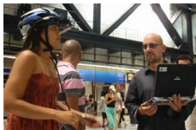
Un exemple de l'équipement filaire du Lutin : pour recueillir le parcours du regard lors de la visite d'une exposition, le chercheur doit suivre le visiteur en portant l'ordinateur qui recueille les données.
