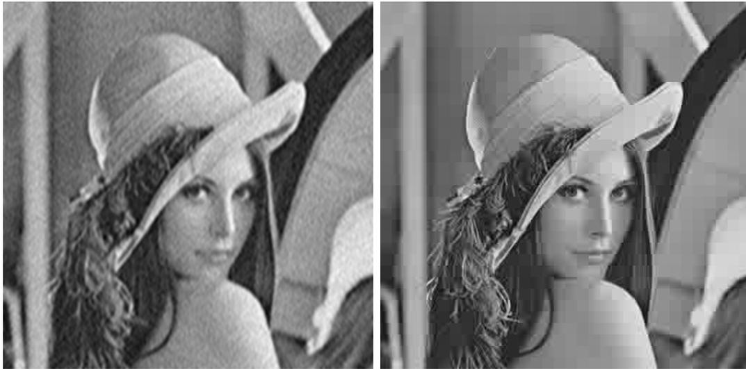
FIGURE 6.5 – Lena compressée : gauche : en prenant les 5000 atomes de DCT 512x512 les plus forts. Droite : en prenant les 5000 atomes de la DCT 16x16. Ces figures sont à comparer à 6.4 et 6.3. On constate une nette amélioration visuelle, bien que le budget de coefficients non nuls n'ait pas changé.
