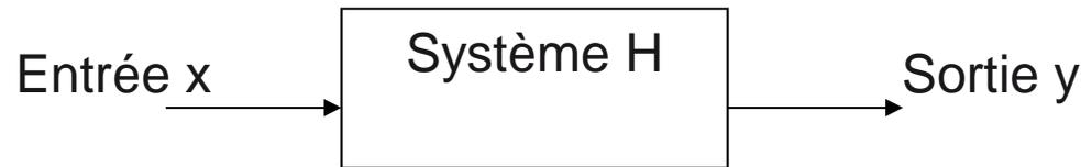
Intuitivement, un système est stable si lorsqu'on supprime l'excitation  $x$ , la sortie  $y$  tend vers une limite bornée.
