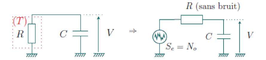
A l'équilibre thermodynamique un système dynamique a, en moyenne, une énergie potentielle égale à  $\frac{kT}{2}$  par degré de liberté :
