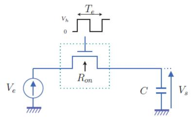
Le transistor MOS, utilisé en commutateur, est caractérisé par une résistance  $R_{on}$  dans le mode d'échantillonnage et par un circuit ouvert en phase de maintien. Pour que la charge de la capacité soit quasicomplète, la période d'échantillonnage  $T_s$  est choisie telle que  $T_e > 7$   $\tau$  avec  $\tau = R_{on}C$ .
