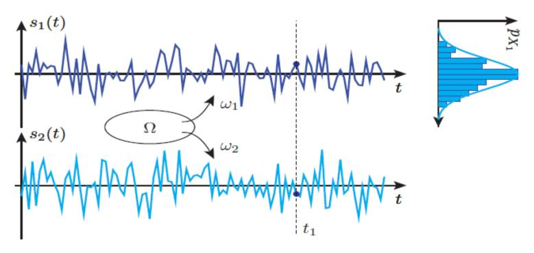
En  $t=t_1$ , on a une variable aléatoire  $X_1=X(t_1)$  de densité  $p_{X_1}$ :
