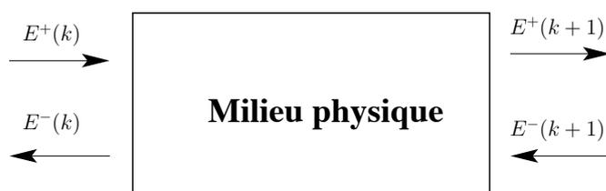
FIG. 5.6 – Représentation en élément à deux ports de la relation liant un milieu physique aux sections élémentaires  $k$  et  $k+1$
