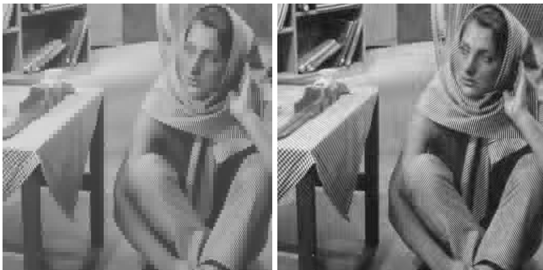
FIGURE 6.9 – Gauche : image barbara compressée de manière adaptative sur la base DCT 8x8. droite : Résultat de l’algorithme matching poursuit avec le même budget de coefficients. On constate que l’algorithme matching poursuit a su bien reconstruire plus de détails haute fréquence. En effet, pour la DCT 8x8, si un détail haute fréquence est plus grand (en support) que 8x8, il faudra plusieurs coefficients pour le reconstruire alors que dans le dictionnaire utilisé pour le matching poursuit, il existe des atomes de tailles plus grande qui peuvent être utilisés.
