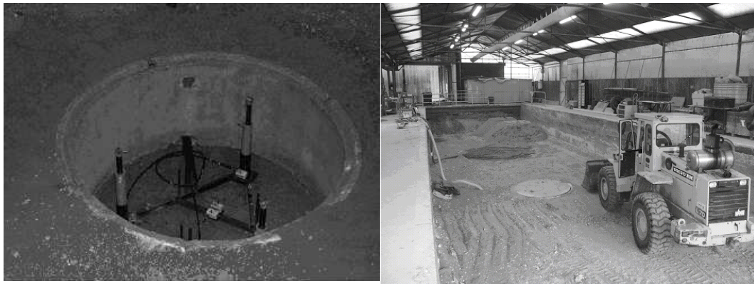
FIGURE IV.3: (Gauche) Les 3 vérins contrôlant un des plateaux. (Droite) Mise en place de l'expérience.
