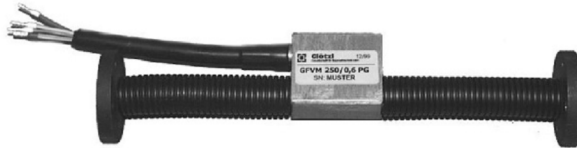
FIGURE I.7: Capteur extensométrique à corde vibrante destiné à être placé à l'intérieur du béton.
