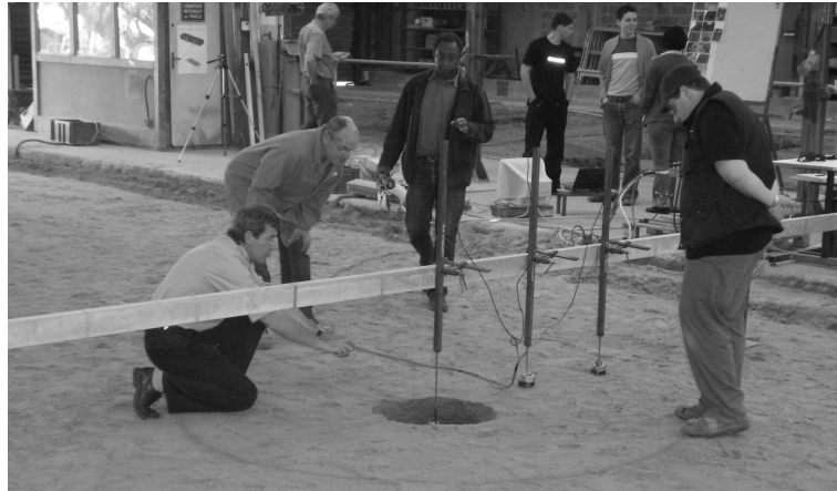
FIGURE IV.11: Remontée en surface de la cavité.
