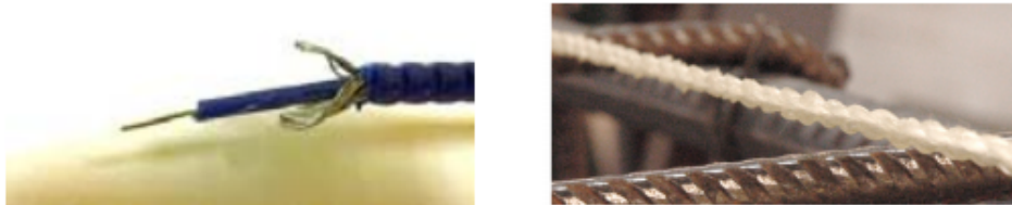
FIGURE 1.12: Photographies du câble au revêtement métallique et plastique (à gauche) et du câble au revêtement tressé époxy/fibre de verre (à droite).
