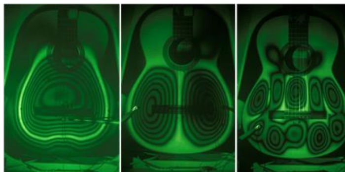
Figure 111. Image holographique des vibrations d'une guitare. Les lignes les plus claires sont les lignes nodales i.e. les endroits où il n'y a pas de vibration.
