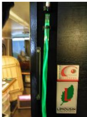
Figure 56. Guidage d'un faisceau laser dans un tube rempli d'eau
