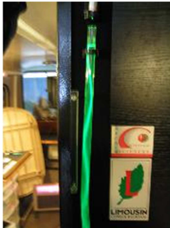
Figure 22. Guidage d'un faisceau laser dans un tube rempli d'eau
