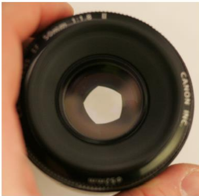
Diaphragme traditionnel à 5 lames et famille \{g_d\}_{d \in D} de noyaux étalonnée.
