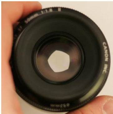
Diaphragme traditionnel à 5 lames et famille \{g_d\}_{d \in D} de noyaux.
