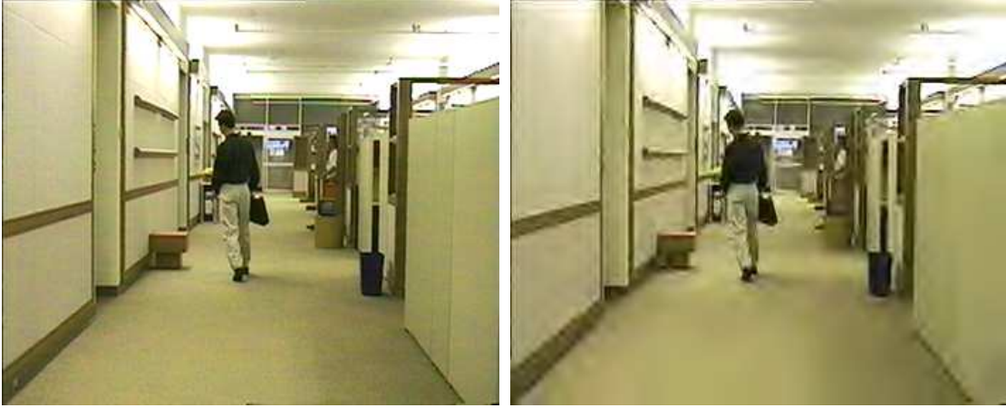
FIG. 9.4 – Compression d'image à l'aide de JPEG2000 : en haut, l'image originale ( 8 \times 3 bits/pixel) et en bas l'image décodée à 0.25 bit/pixel (c'est-à-dire, une compression d'un facteur 96 pour une image couleur). Le rapport signal sur bruit de codage vaut 28.17 dB en valeur crête (PSNR). JPEG2000 repose sur l'emploi de bases bi-orthogonales d'ondelettes. Les coefficients d'ondelettes sont quantifiés d'autant plus finement que leur amplitude est grande. Une stratégie de codage assez sophistiquée est également mise en œuvre afin d'atteindre de forts taux de compression.
