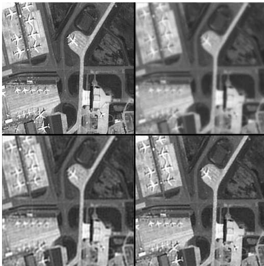
FIG. 8.9 – Exemple de restauration. De haut en bas et de gauche à droite : image originale (image Spot 5 ©CNES 2002); image dégradée par convolution et ajout de bruit; image restaurée par Wiener; image restaurée par minimisation de l'énergie (8.13).
