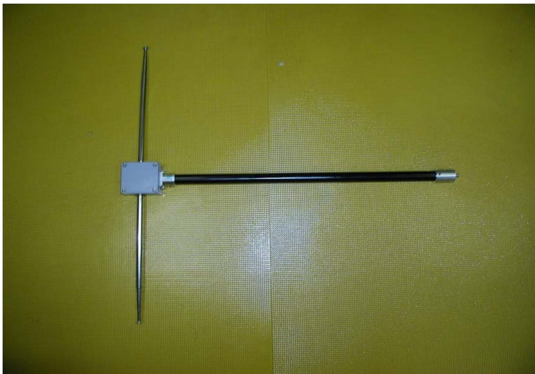
**Figure 28 : dipôle basse-fréquence avec des brins télescopiques**
