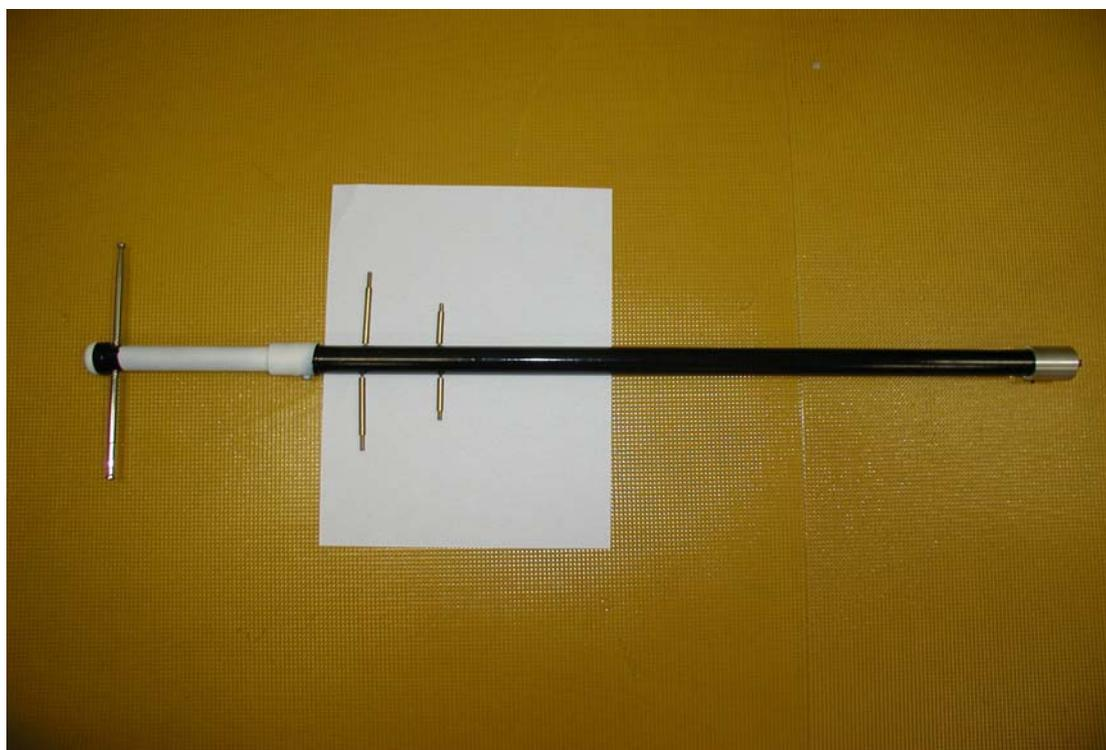
**Figure 29 : dipôle haute-fréquence avec des brins à visser**
