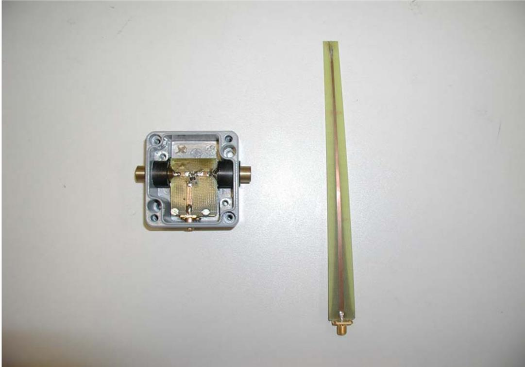
Figure 30 : balun basse-fréquence (à gauche) et balun haute-fréquence (à droite)
