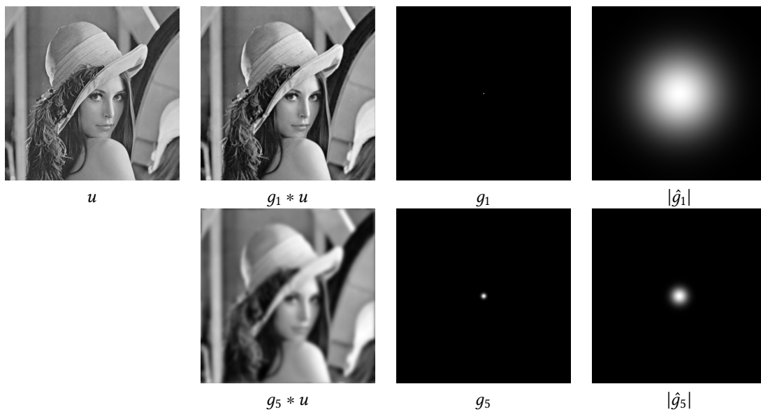
FIGURE 7 – Flou gaussien. Sur la première colonne, on montre une image u . Sur la deuxième colonne, on montre l'image floutée g_s * u où g_s est le noyau gaussien d'écart-type s . Sur la troisième colonne, on montre le noyau g_s et sur la quatrième colonne son spectre centré. Plus s est grand, plus le noyau g_s est étalé en espace et plus g_s * u paraît flou. À l'inverse, lorsque s grandit, le spectre |\hat{g}_s| est moins étalé (et donc le filtrage par g_s détruit une plus grande partie du spectre).
