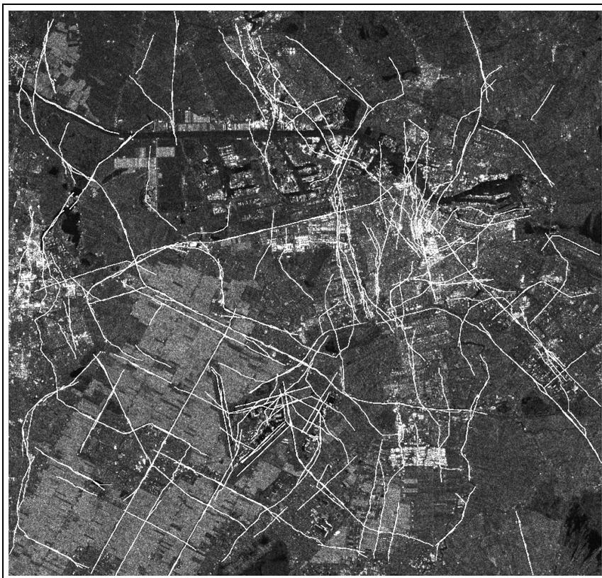
b. Résultat de la détection des routes superposé à l'image originale.
