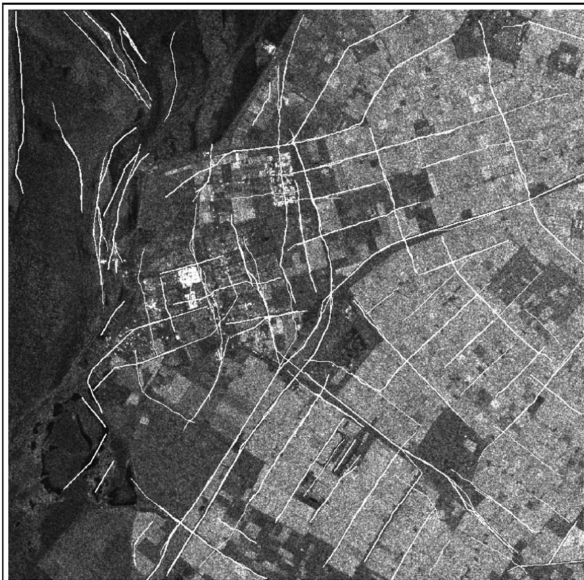
b. Résultat de la détection des routes superposé à l'image originale.
