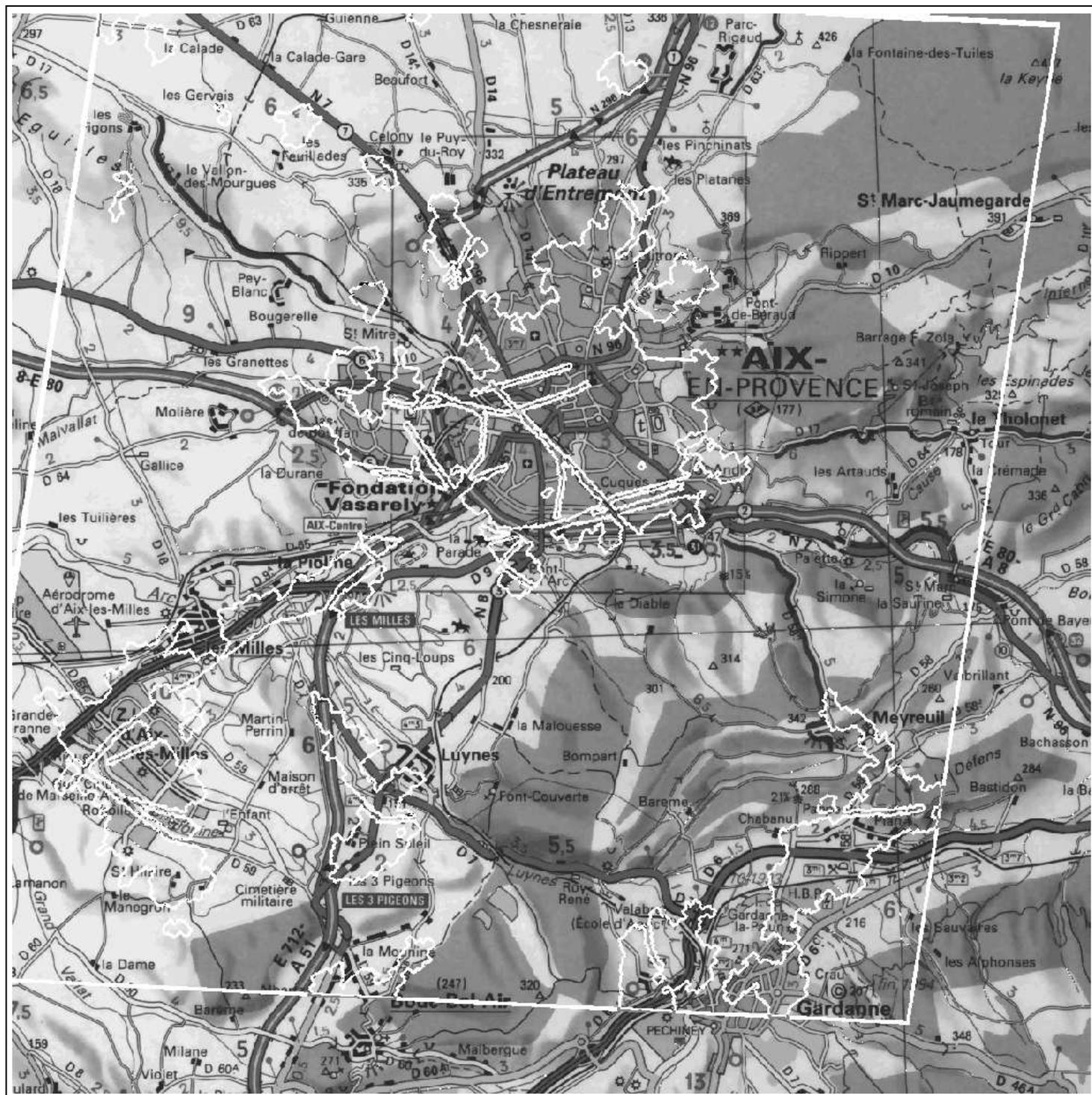
FIG. B.8 – Superposition des zones urbaines de l'image radar et de ses bords (en blanc) après application de la transformation de recalage sur la carte pour l'image d'Aix-en-Provence.
