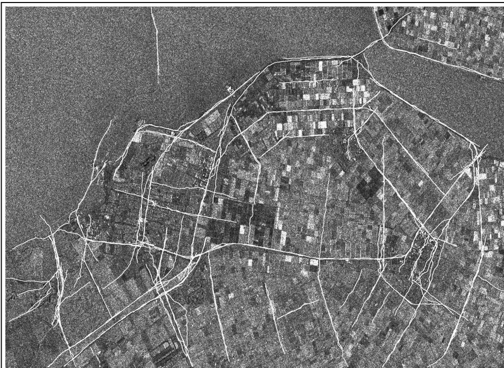
b. Résultat de la détection des routes superposé à l'image originale.
