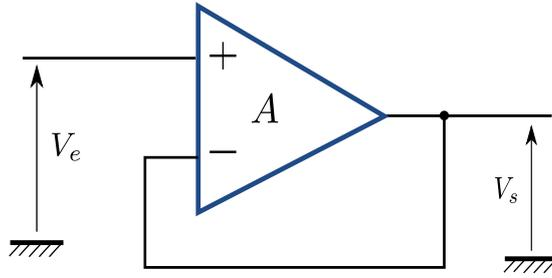
FIGURE 3 – Amplificateur suiveur
