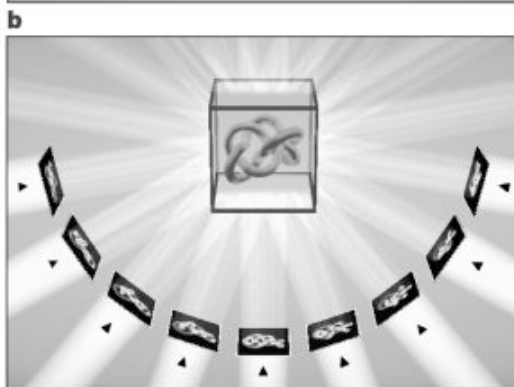
Calcul d'un volume de reconstruction 3D par rétroprojection
