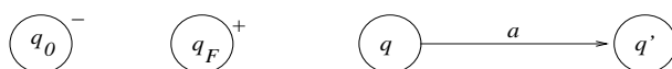
FIG. 3.1 – Représentation graphique de l'état initial q_0 , d'un état final q_F \in Q' et d'une transition \delta(q, a) = q' .
