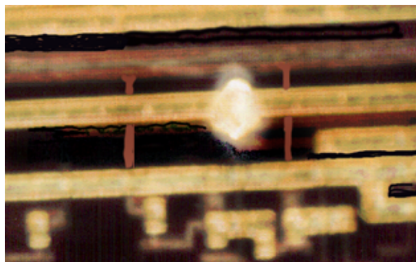
Planche 3.19 – Poussière de 6 \mu\text{m} sur un circuit
