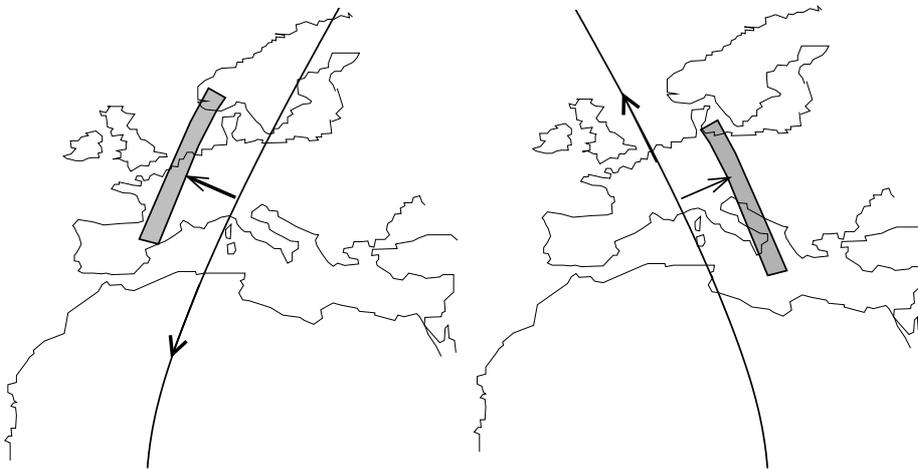
FIG. A.6 – Capteur RSO visant à droite. Passe descendante (à gauche) et passe montante (à droite).
