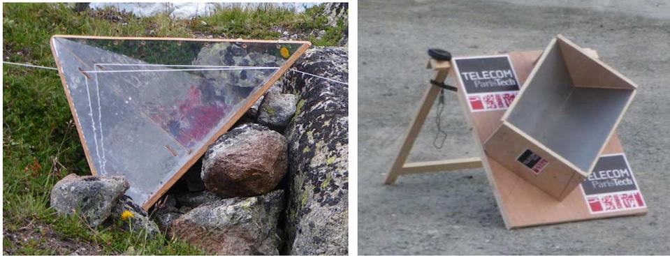
FIG. 2.1 – Cibles canoniques. A gauche, trièdre en bordure du glacier d’Argentière. A droite, dièdre dépolarisant en test à Argentière.
